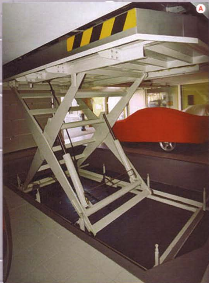
25 Piattaforma porta auto a scomparsa con piano rotante
