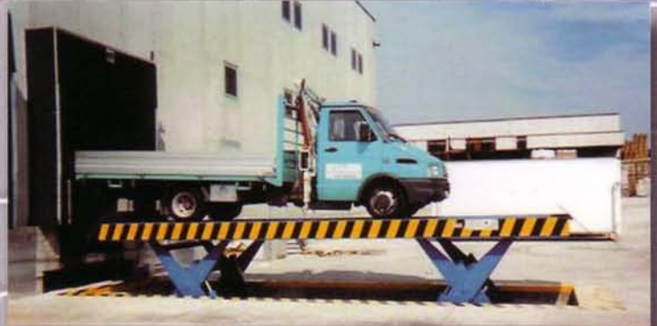
14 Piattaforma elevatrice per sollevamento automezzi
