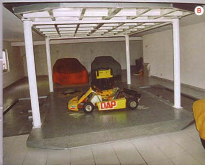
25 Piattaforma porta auto a scomparsa con piano rotante
