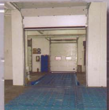
19 Sistema di tappeti a sfera per la preparazione di pallets aerei
