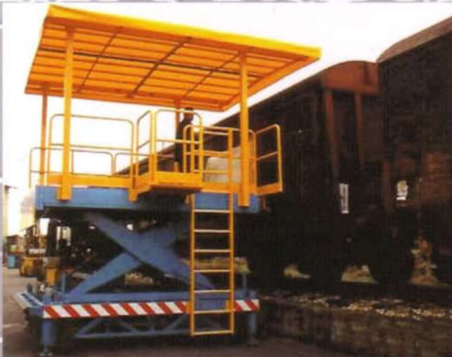
13 Piattaforma elevatrice per il carico/scarico di vagoni ferroviari
