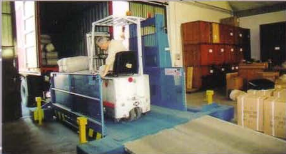
15 Piattaforma elevatrice carrellata a montante per il raccordo tra automezzo e piano magazzino
