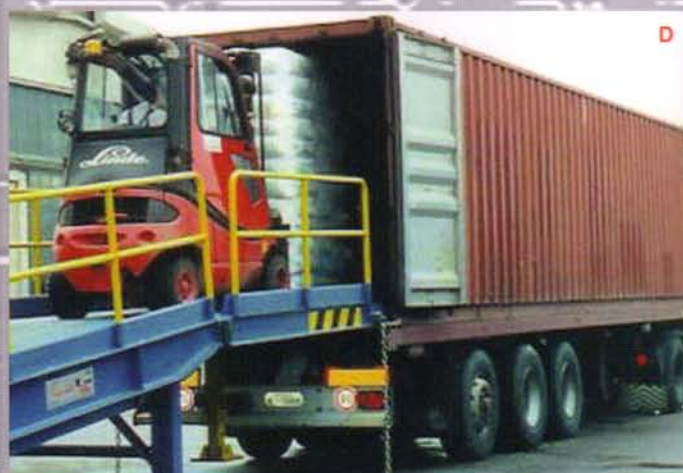
8 Rampe di raccordo da piazzale per il superamento di dislivelli elevati e il carico/scarico di automezzi, container e carri ferroviari.
