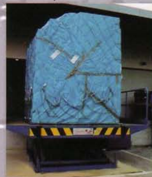
18 Piattaforma con ubicazione esterna per il carico di pallets aerei
